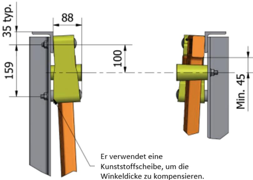
Der Stützblock wird unter der oberen Schiene des Tors montiert, um eine vertikale Durchbiegung zu verhindern.
