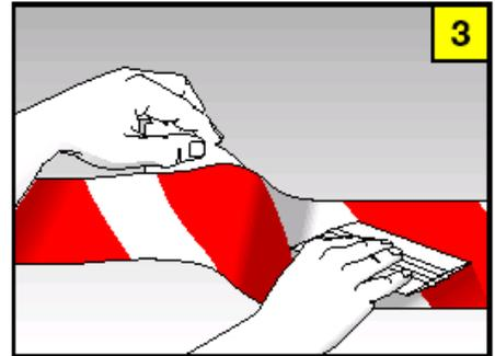
3. Schutzpapier langsam unter der Folie abziehen und gleichzeitig mit Plastikraker andrücken.
