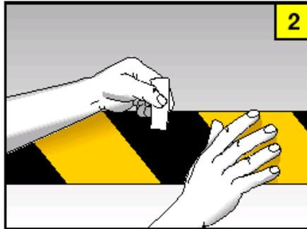
2. Folie an der zu markierenden Oberfläche ausrichten, ggf. mit Klebestreifen an Hilfslinien positionieren und den Folienteil ohne Schutzpapier mit Plastikraker andrücken.
