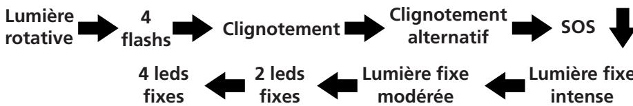
Pour éteindre la balise lumineuse sans passer par les 9 modes, appuyer sur le bouton Marche/Arrêt pendant 2 secondes. 2 leds vont clignoter 5 fois, puis la balise va s'éteindre. Pour la mettre en marche à nouveau, appuyer sur le bouton Marche/Arrêt, la balise va se rallumer sur le dernier mode sélectionné avant l'arrêt.
